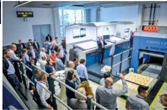
İstif lojistiği ve kapsamlı otomasyon özellikleriyle Rapida 145'te (1.060 x 1.450 mm) yüksek hızlı üretim
