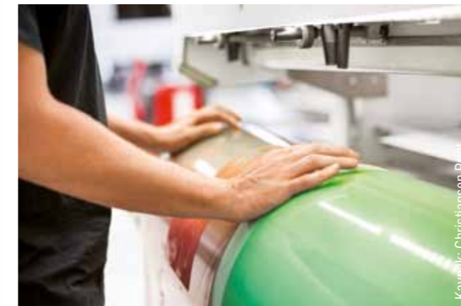
Twinlock Siliv üzerine klişe montajı.
