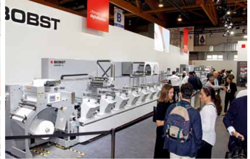
Master M5 fleksonun mürekkep haznesini ortadan kaldırıp ofsetlerdeki teknolojiye benzer aniloks ile baskı merdanesi arasına mürekkep püskürtme usulü ile ünite başı sadece 30 gram mürekkep tüketimi ile baskı yaptı.
