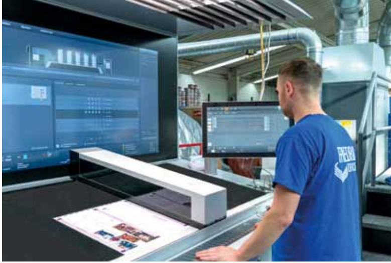
Offset Friedrich, yeni Prinect Press Center donanımlı bir Speedmaster XL 75 ile üretim yapıyor. Deneyimleri, saatte 16.500 sayfalık artan baskı hızının çoğu baskı altı tabaka için tutarlı ve istikrarlı bir şekilde kullanılabileceğini gösteriyor.
