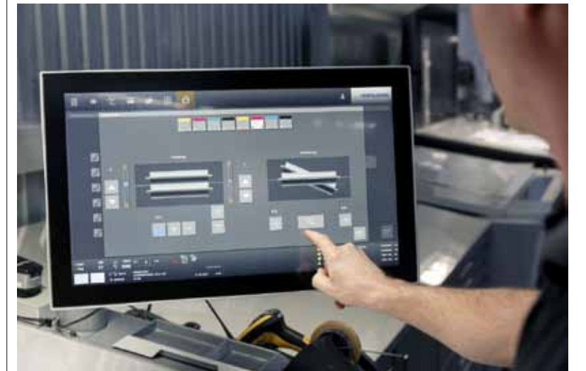
Yeni Hycolor Pro ile nemlendirme ünitesinde şimdi Prinect Press Center XL3'ten dijital olarak ince ayar yapılabilir. Bu, zamandan ve emekten tasarruf sağlıyor ve üretim sırasında bile kontrol panelinden en iyi düzeltmeleri mümkün kılıyor.
