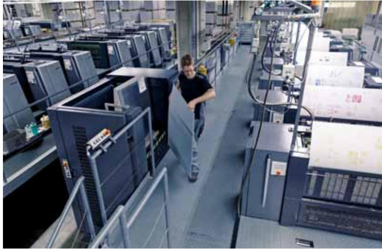
Aumüller Druck yeni "Plate to Gallery" baskı kalıbı lojistiğini kullanıyor. Matbaacıları fiziksel olarak rahatlatıyor ve uzun yolların ortadan kaldırılması ek zaman kazandırıyor.
