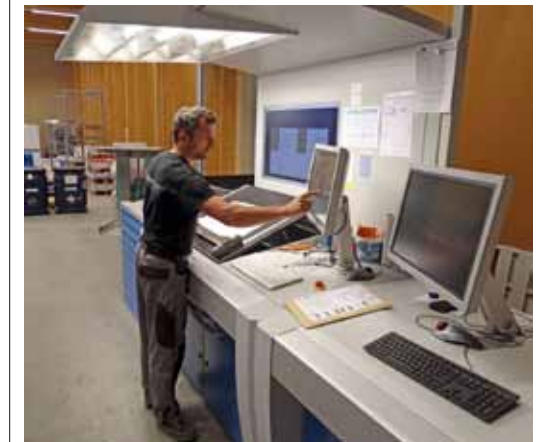
Operatör Tobias Krauß, Rapida 76 konsolunda. Baskı makinasının kullandığı kapsamlı ölçüm ve kontrol sistemleri, hat içi renk kontrolü, sürekli üretim izleme ile tabaka muayenesi ve basılı tabakaların baskı öncesi PDF ile karşılaştırılmasını içeriyor
