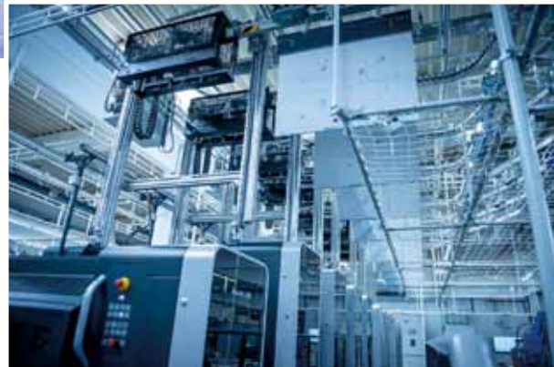
Yeni: Makina üzerinde yükleme kanallarına doğru PlateTronic kalıp lojistikleri. CtP'den aradaki kalıp istifine ve hatta kalıp değiştiriciye, tüm süreçler tam otomatik çalışıyor
