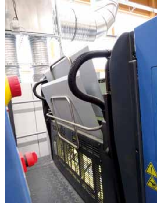
Tam otomatik FAPC kalıp değiştiriciler daha hızlı hazırlık sürelerine önemli bir katkı sağlıyor
