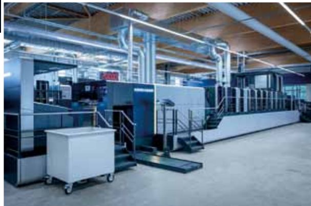
Ambalaj üretimi için yükseltilmiş kaide üzerinde 7 baskı ünitesi, çift lak, ilk lak ünitesinden sonra ilave bir baskı ünitesi ve soğuk yaldız sistemi FoilTronic ile bir Rapida 106 X
