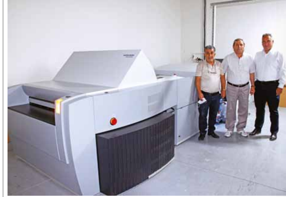
Özyurt Matbaacılık'a kurulan Suprasetter CtP saatte 55 kalıp hızında, çift kasetli, 70 x 100, pançlı ve çift vardiya çalışıyor. Matbaanın kalıp ihtiyacı aylık 17 – 20 bin arasında değişiyor.
