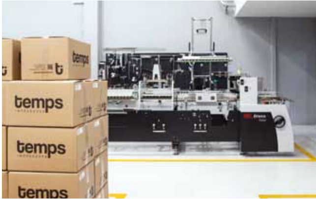
MK Diana Easy katlama yapıştırma makinesi, hızlı bir hazırlık süreci ve sunduğu yüksek kalite ile karakterize olup, çok çeşitli uygulamaları ve çeşitli malzemeleri işliyor.
