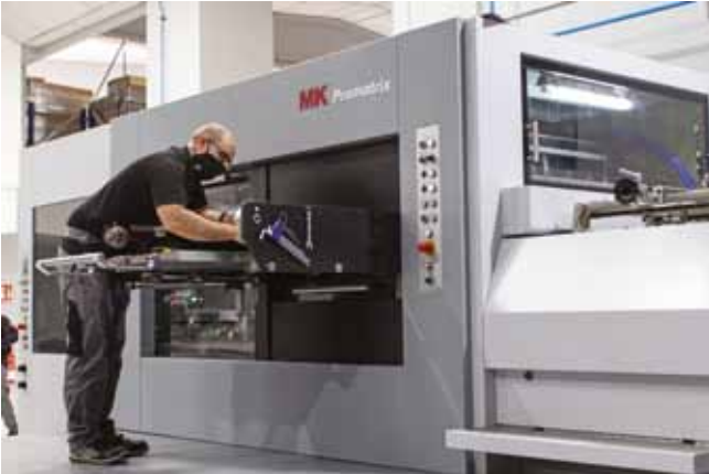
Yeni MK Promatrix 106 CSB'nin kullanımı kolay ve kurulumu hızlı. Hat içi, ayıklamalı profesyonel bir kalıplı kesim ve kabartma makinesi.
