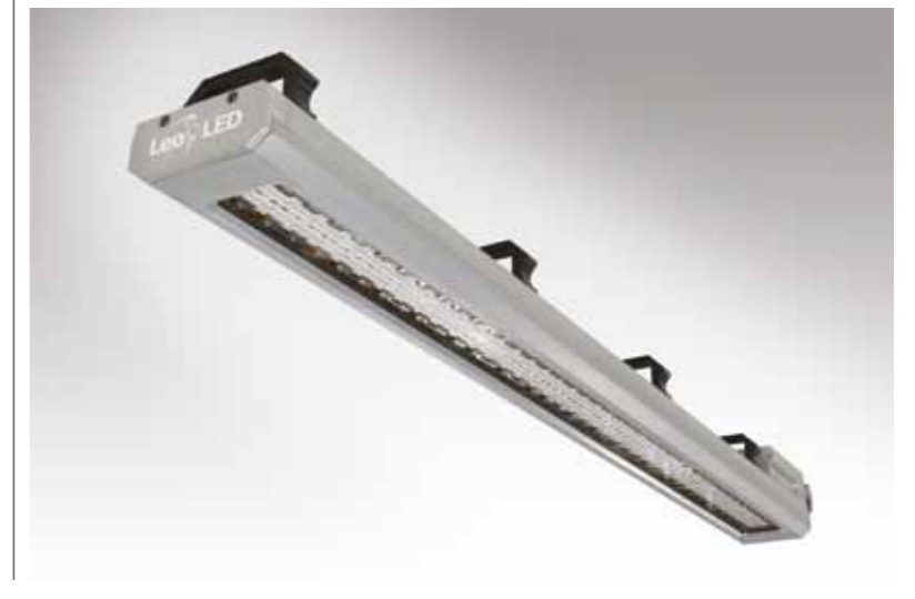
GEW LeoLED UV Lamphead, kompakt 40 x 100 mm profil ile su soğutmalı ve herhangi bir tabaka beslemeli baskı makinesine sorunsuz bir şekilde entegre edilecek şekilde özelleştirilebiliyor
