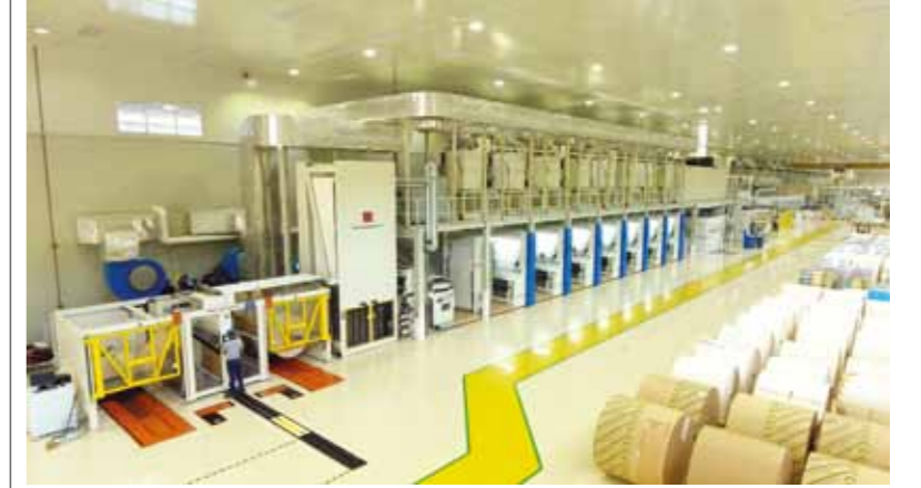
Sanand / Hindistan'daki Asepto fabrikasında 500 m / dak çıktı ile ilk Heidelberg Intro web flekso baskı makinesi.
