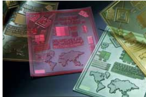
Flekso baskıda kullanılan fotopolimer kalıplar
