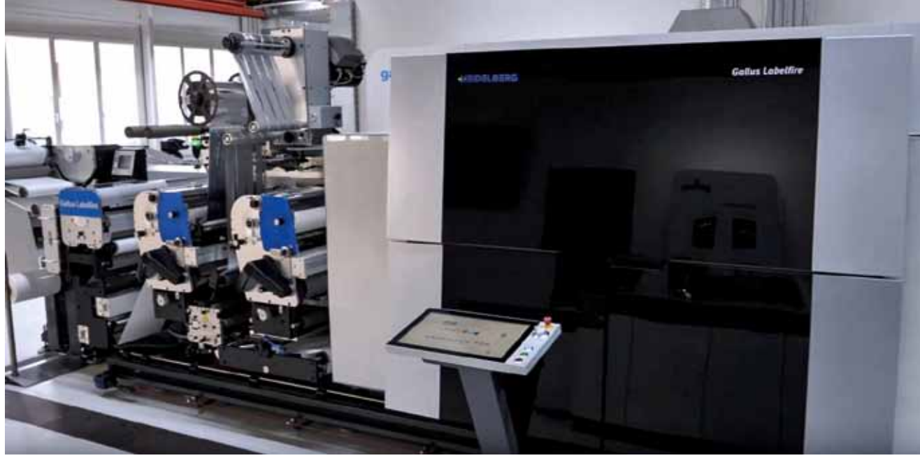
7 renk artı beyaz UV inkjet dijital baskı ünitesinden önce iki flekso baskı ünitesine sahip Gallus Labelfire (Kaynak: Gallus Ferd. Rüesch AG)
