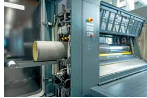
Aniloks merdane değişimleri, AniSleeve teknolojisi sayesinde aletlere ihtiyaç duymadan tek bir kişi tarafından hızlı bir şekilde gerçekleştirilebiliyor.
