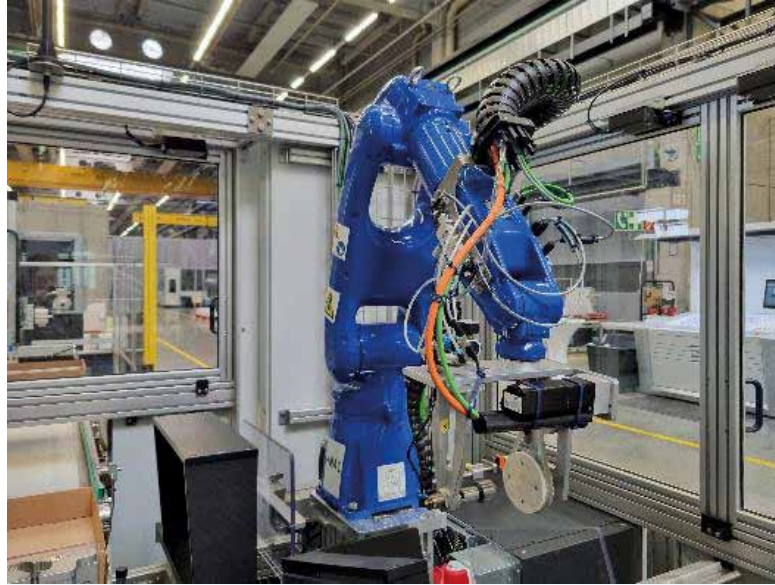
DIENST'den robot çözümü: Robot, etiket paketini alıyor ve nakliye kutusuna yerleştiriyor; DC-12 RAPID, Heidelberg'deki İnovasyon Günleri etkinliğinde
