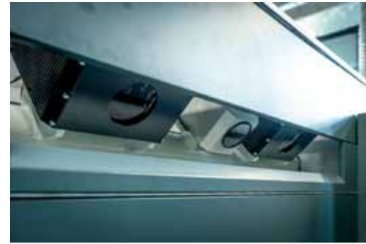
260 dpi'ye kadar çözünürlüklerde hat içi renk kontrolü (ortada) ve tabaka muenesi için kameralar üretim sırasında her bir tabakayı kontrol ediyor; hatalar ve kusurlar büyük ekranda görselleştiriliyor ve kaliteyi doğrulamak için raporlar üretiliyor.
