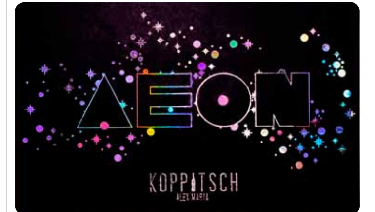
AEON etiketi: Siyah mat kâğıda uygulanan gökkuşağı soğuk folyo, Dijital Süsleme Biriminde (DEU) dokunsal parlak laklı müşteri logosu “Koppatsch” (Kaynak: pack.consult)
