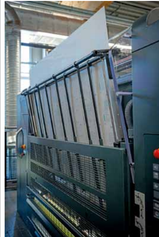
DriveTronic SPC: Bükülmemiş baskı kalıpları ile tam otomatik plaka değişimi.
