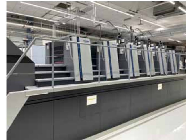
Ravensburger'de saatte dört ya da beş iş değişikliği ile baskı hazırlık süreçlerinin hızı, üretimin ne kadar uygun maliyetli olduğunu belirliyor; burada gösterilen baskı makinesi Speedmaster XL 106-5 + L
