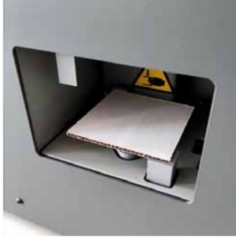
SST - Kesim Sertliği Testi (SST): test soketi
