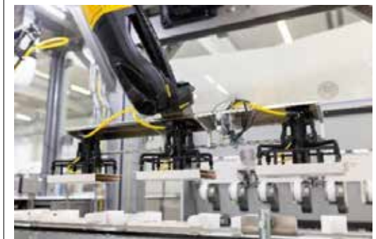
Altı eksenli bir robot karton kaplamalar diker (Telif Hakkı: R. Weiss)
