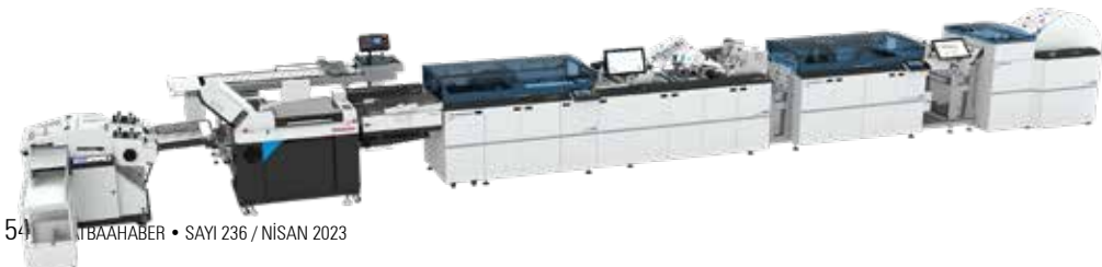
Hunkeler Generation 8, Dinamik Processor DP8 ve Horizon katlama makinesi ile Doğrudan Posta için rulodan balta çantalı çözüme
