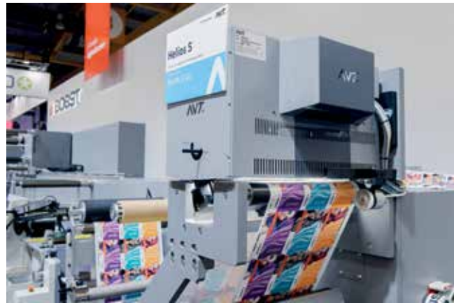
Yeni Esko AVT Vernik Kontrol modülü tüm AVT Helios R, B, S, Turbo+, Turbo HD ve Turbo HD+ sistemlerinde kullanılabilir.
