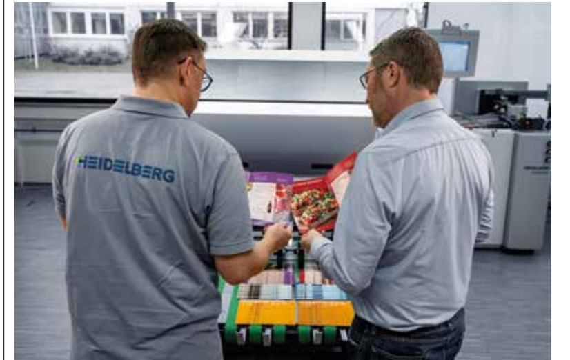
Heidelberg, kesilmiş ve katlanmış ürünlerin üretimi için Stahlfolder Fireline konseptini geliştirdi. Bu makine, A3 ve A4 son formatlarındaki posterlerden ve dört sayfalık broşürlerden, konsertina, paralel, mektup veya kapaklı katlamalı sekiz sayfalık A6 ürünlere kadar çok çeşitli ürünler üretebiliyor.
