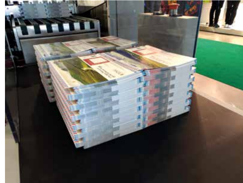
Tecnau Stack 1010 kesme ve istifleme, mürekkep püskürtmeli çıktıyı Heidelberg Jetfire 50'ye hat içi veya hat yakını olarak kartpostal, poster ve diğer tam taşmalı basılı uygulamaların bitmiş istiflerine dönüştürmek için tek sayfalık bir işleme sistemi.
